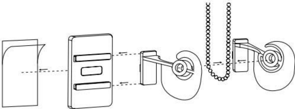
3.1 а)Если вы используете цепь-петлю, то перед сборкой натяжителя необходимо накинуть цепь на одну из его половинок. б)Если вы используете обычную цепь, то необходимо заменить соединитель цепи на безопасный, собрать натяжитель, затем продеть цепь через него.
